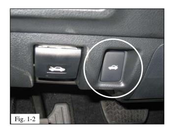
(d) Use the switch on the dashboard to open the trunk (Fig. 1-2).
